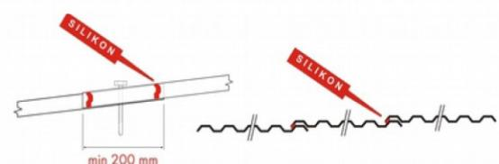
Všechny spoje je vhodné dotěsnit silikonem. Používejte výhradně silikon na polykarbonáty dodávaný spolu s deskami (je testován na chemickou snášenlivost výrobcem).
