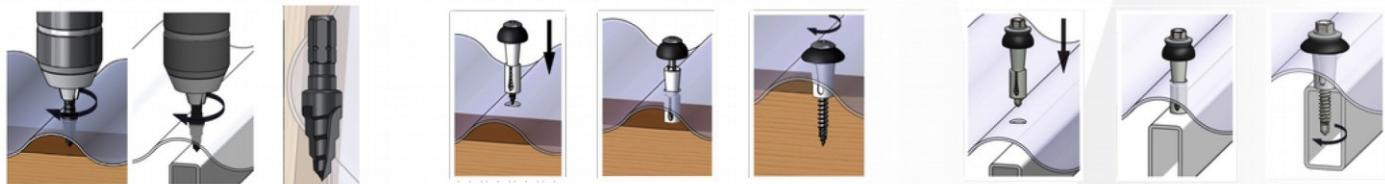
Při bočním napojování překládejte desky minimálně jednu celou vlnu, desky WT doporučuje výrobce překládat 2 vlny. Na horní a spodní straně přístřešku (první a poslední příčná lať) šroubujte na vrcholu každé druhé vlny, na vnitřních nosnících ideálně na vrcholu každé třetí vlny. Počet připevnění viz technický list konkrétního typu desky.
