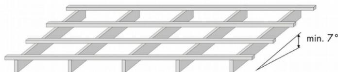
Na nosnou konstrukci nalepte spodní pěnové těsnění - mikropryž (v nabídce je v šířích 30; 50 a 60 mm, síla 3 mm, jednostranně samolepící). Zabraňte kontaktu PC desek s laky, mořidly, rozpouštědly a jinými chemickými látkami. Používejte pouze dodavatelem doporučené doplňky, které jsou testované na chemickou snášenlivost, v opačném případě hrozí narušení povrchu desek, jejich naleptání až popraskání.
