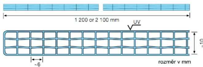
Jestliže se Makrolon® multi UV 4/10-6 používá na prosklení střech nebo stěn, síly působící vlivem větru a sněhu musí být absorbovány pomocí vhodné zvolené konstrukce. Doporučujeme instalovat rozteče podpor pro dané zatížení dle zátěžového diagramu.
